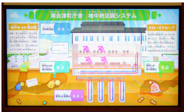
町役場本庁舎の地中熱空調システム
