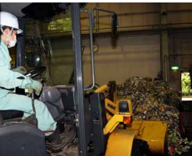
写真① ローダーを器用に操作し、粗大ごみ 供給コンベアへ。粗大ごみは、順次 破砕機へ運ばれ、選別・回収がしやす いよう細かく粉碎される
