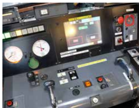
写真⑤ 運転席でシステム機器の動作を確認するとともに、発せられる「音」もチェック
