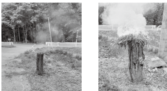
トーチの燃焼実験の様子
