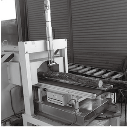
原木を非破壊検査機で検査
