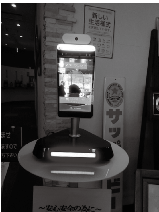
体温測定カメラ設置のようす
