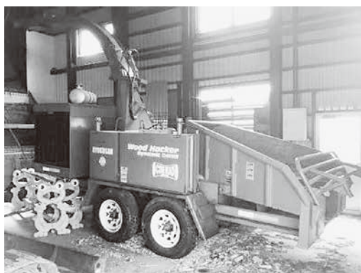
チップ生産保管施設内にある木材破砕機
