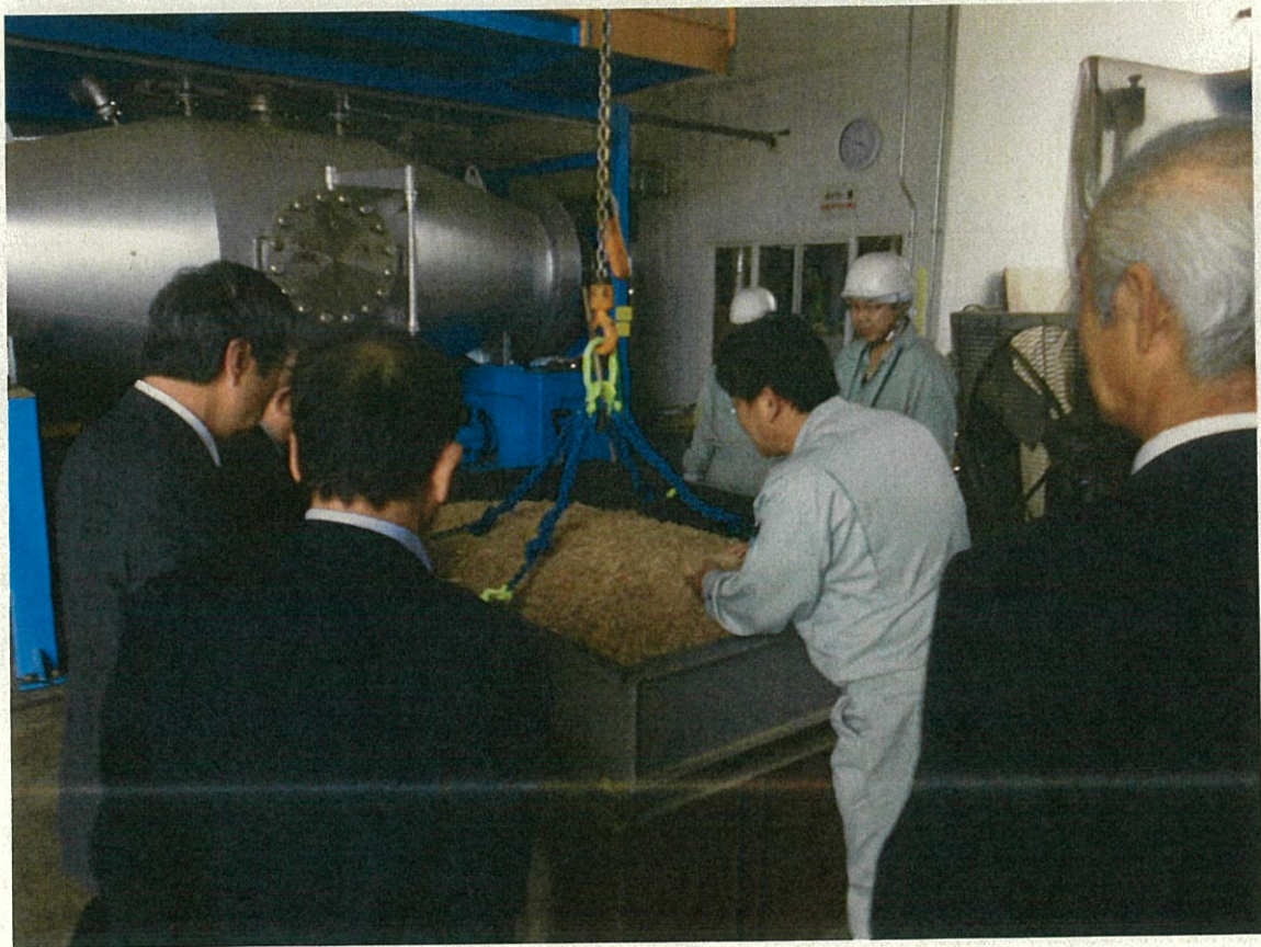
木質飼料製造機械（チップの投入）
