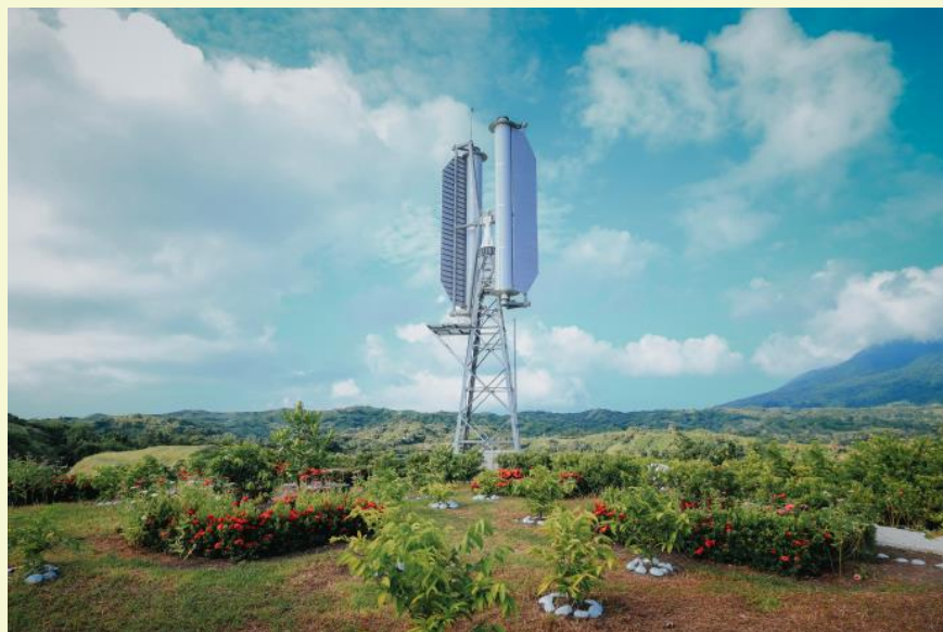
フィリピンのバタン島に設置されている、プロペラを持たない風力発電機
