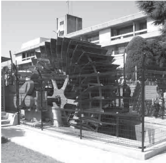
小水力発電「元気くん1号」(山梨県都留市) 写真：都留市ホームページより
