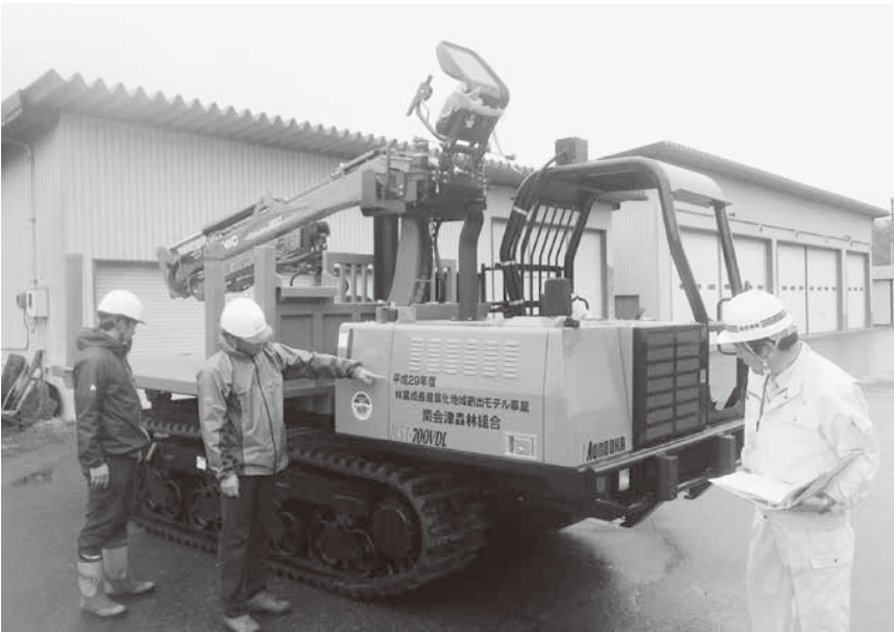
高性能林業機械 グラップル付きフォワーダ（平成30年5月導入）
