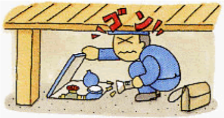
③メーターボックスが床 下や屋内にあつて検針 に支障が出るときは、 検針しやすい場所への 移設
