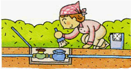
②メーターボックス内の 清掃(周辺の草刈りや 土砂の除去など)。
