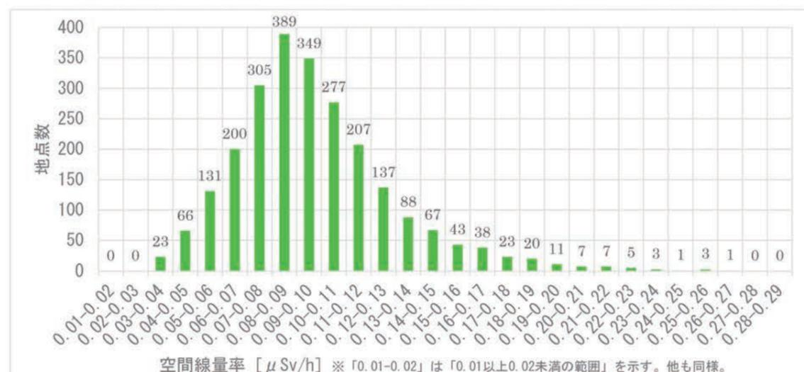
図1：避難指示・解除区域市町村外におけるリアルタイム線量測定システムの平均空間線量率分布
