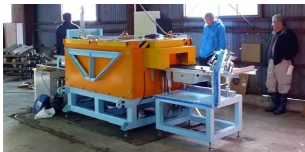
きのこ原木用非破壊型放射能検査装置 (平成28年1月27日撮影)
