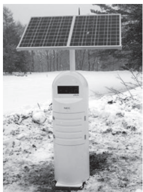
町内43か所に設置されたリアルタイム線量計
